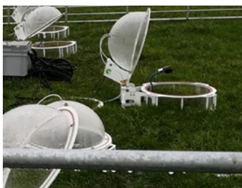
Regionale fieldlabs die effect kleitoepping op CO 2 emissies en bodemdaling in het veld meten
