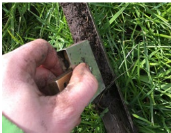
Monitoring klei inspoeling door het nemen van standaard volume veenmonsters op verschillende plekken in het veenprofiel
