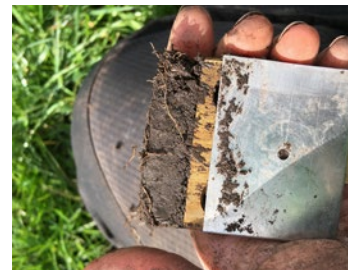
Monitoring klei inspoeling door het nemen van standaard volume veenmonsters op verschillende plekken in het veenprofiel
