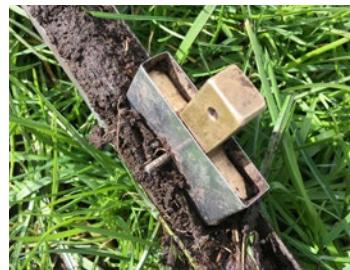
Monitoring klei inspoeling door het nemen van standaard volume veenmonsters op verschillende plekken in het veenprofiel
